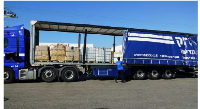
וילון להובלת מטען קל יש לקשור ולאבטח את המטען ללא קשר לוילון. גג נייד במשאית מאפשר בנוסף ריתוק ואבטחת מטען קל.
