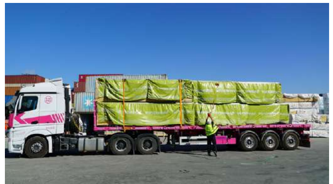
חבילות עץ קשירת לוחות עץ, באמצעות רצועות של 2 טון לפחות (צבע ירוק), כל חבילה בנפרד, בשתי נקודות. יש להצמיד את חבילות העץ לדופן הקדמית. יש לוודא התקנת קרש הגבהה לכל חבילה, לצרכי פריקה וטעינה.
